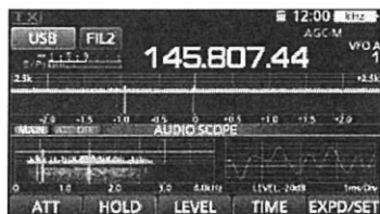
Ekran mini analizatora widma z ekranem zakresu audio (AUDIO SCOPE)
